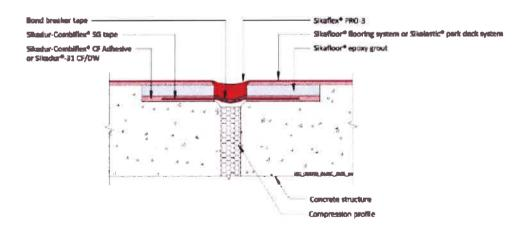
Aplicação do sistema de impermeabilização para juntas de dilatação do tipo "Sikadur Combiflex SG" da Sika ou equivalente, dimensões a definir em função da junta a tratar e selagem superficial do tipo "mástique de poliuretano Sikaflex Pro-3 Purform" da Sika ou equivalente.
