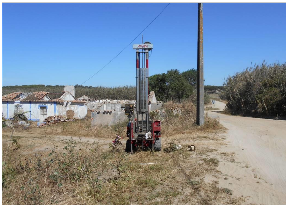
Foto 3 – Local de realização da sondagem DPSH S2 no Moinho do Vau na zona de implantação da EE.
